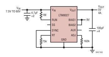
5V V<sub>OUT</sub> Step-Down Converter
