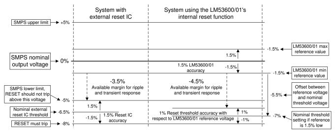
Figure 8-6. Reset Threshold Voltage Stack Up
