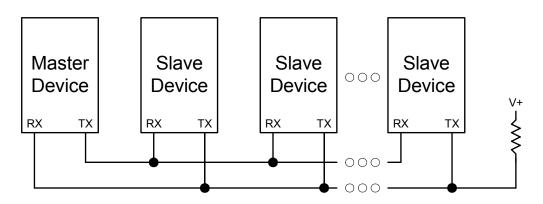
Figure 30.6. UART Multi-Processor Mode Interconnect Diagram
