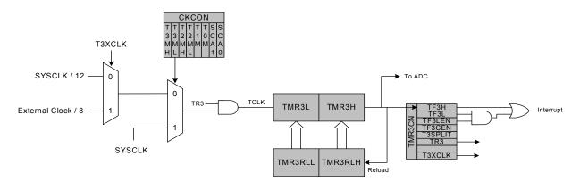
Figure 31.7. Timer 3 16-Bit Mode Block Diagram
