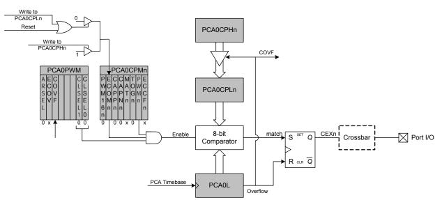
Figure 32.8. PCA 8-Bit PWM Mode Diagram
